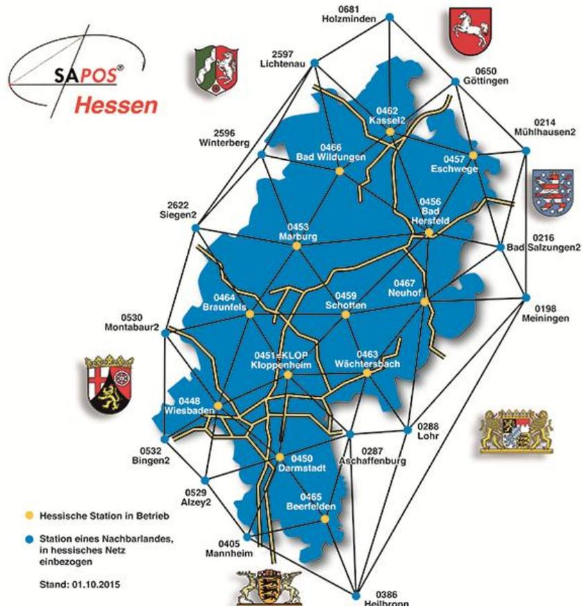
Abb. 1: Hessisches SAPOS®-Referenzstationsnetz mit Wächtersbach (bis 30.11.2015)
